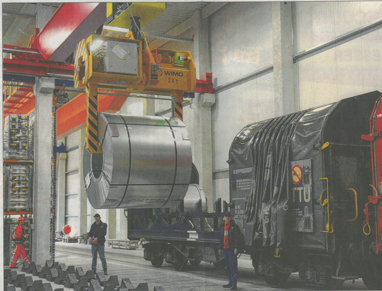
ENTLADEN: Mit einem großen Kran werden die Blechrollen von den Güterwagen geholt, die direkt in die neue Lagerhalle der Spedition Hartmann in Muggensturm hineinfahren können. Foto: Collet
